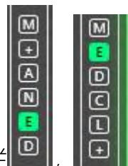
在输入和输出通道中间的按钮栏，为对应所有输入输出通道该功能按钮的总开关，将会直接对所有输入通道同时操作。
