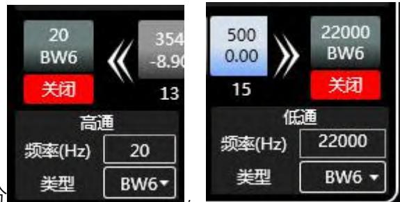
如上图6.1所示，左右下角所示的高通或低通部分可控制开关、高低通的频率及类型。
