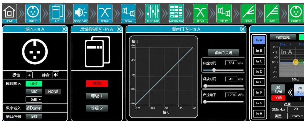
各功能模块通过控键打开关闭，显示功能页面和详细参数，可以进行详细设置，自由对单个或多个功能进行操作。可以左右拖动切换不同功能页面。
