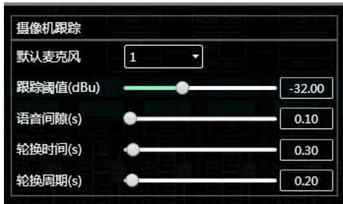
**默认麦克：**指所有的麦克都没有输入时，转动摄像机到默认 MIC 设置的位置或者发送默认麦克定义的关联命令。
