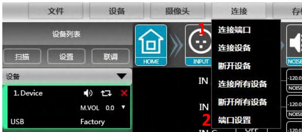
设备可以通过RS232或RS485控制，根据摄像机所需波特率设置相对的波特率。（设备与摄像机波特率需要一致）
