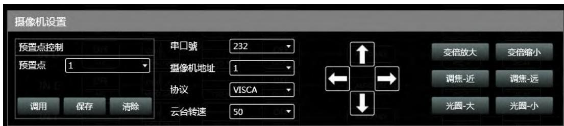
摄像机设置是一个摄像机调试界面，一般在跟踪开始前调试好摄像机位置，最后该部分的参数将保
