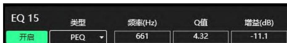
如上图6.1所示，EQ控件下方是EQ参数调节项，可精准控制EQ的开关、类型、频率、Q值、增益等参数。
