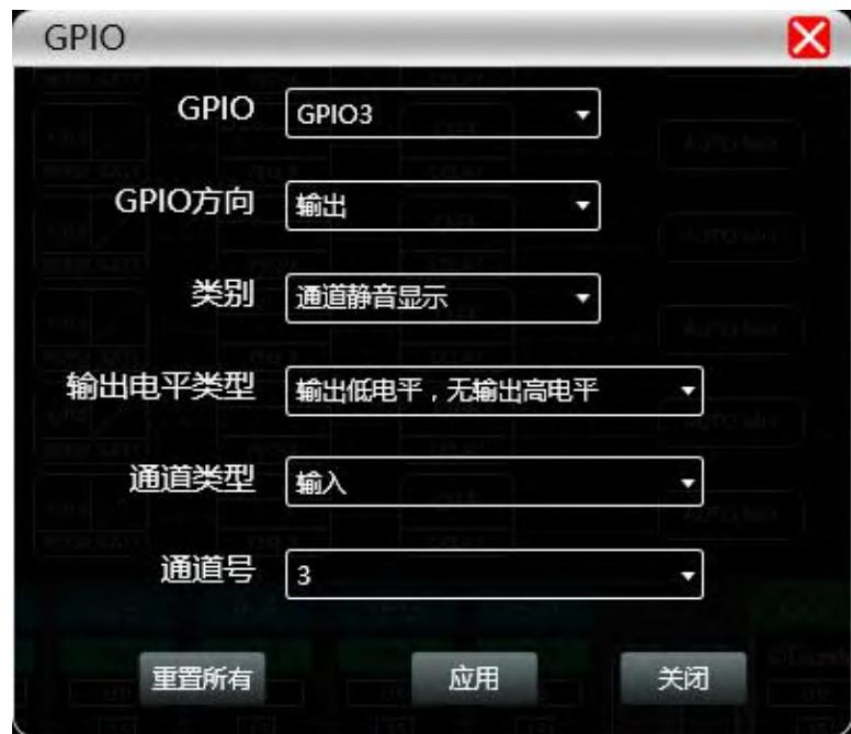
4、选择GPIO方向为**输出**时，如下图设置，点击下方“应用”使之生效。当设备“系统”设置为“静音”时，GPIO 4口输出低电平，可通过更改输出电平类型，以获得同样效果。
