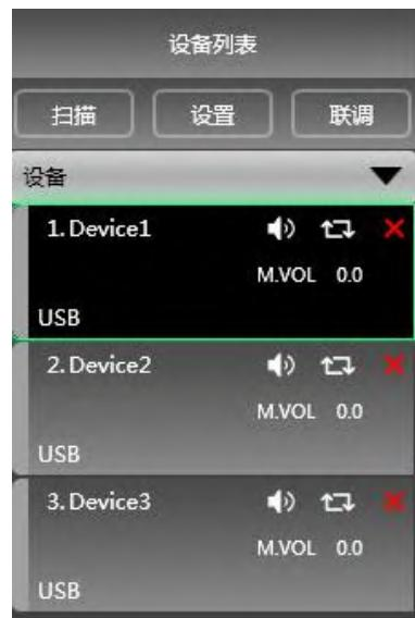
当软件扫描到或手动新增模拟设备时，自动回将对应的设备添加到设备列表中，方便用户对所需要的设备进行交互操作，及方便同时操作多台设备。
