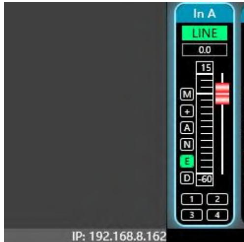
当软件打开时，则会自动获取当前电脑系统已生效的网络适配器对应网络连接的IP地址，方便管理设备IP地址。
