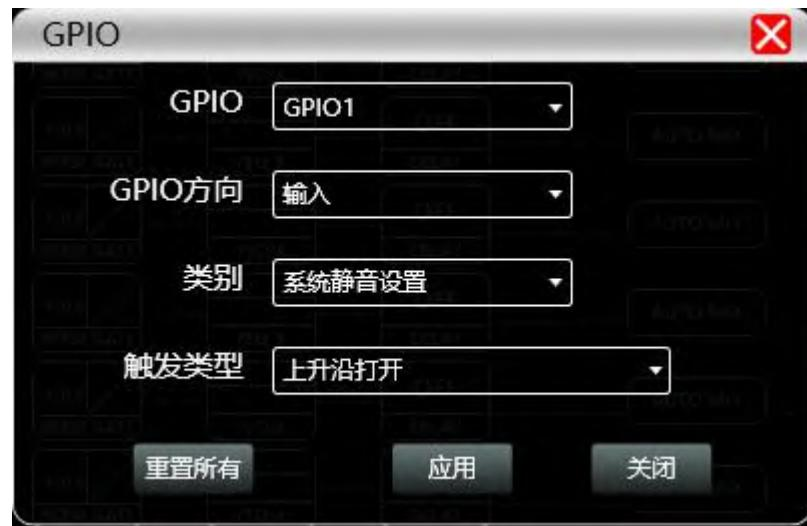
10、选择GPIO方向为输入时，如下图设置，点击下方“应用”使之生效。当GPIO 1 口触发上升沿打开时，可通过232口发出指令。可通过更改指令内容，以获得同样效果。
