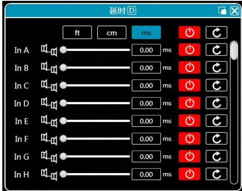
图7.1输入延时设置模块
