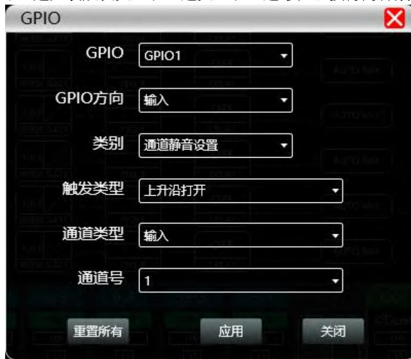
9、选择GPIO方向为**输入**时，如下图设置，点击下方“应用”使之生效。当GPIO 1 口触发上升沿打开
