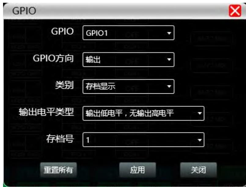
2、选择GPIO方向为**输出**时，如下图设置，点击下方“应用”使之生效。当设备“输出通道 1”的电平值达到-20dB 时，GPIO 2 口输出低电平，可通过更改输出电平类型、通道号、电平阈值，以获得同样效果。
