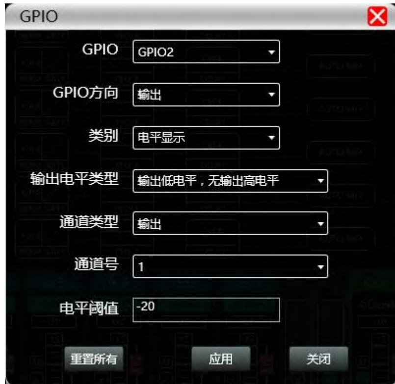
3、选择GPIO方向为**输出**时，如下图设置，点击下方“应用”使之生效。当设备“输入通道 3”设置为“静
