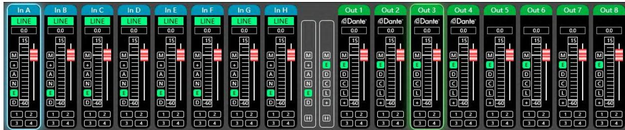
可显示出各通道电平、增益、输入模式、通道名称等信息，控制对应通道增益、DSP功能总开关，可以打开输入输出通道分组联调功能，实现更强大的操作便利性。
