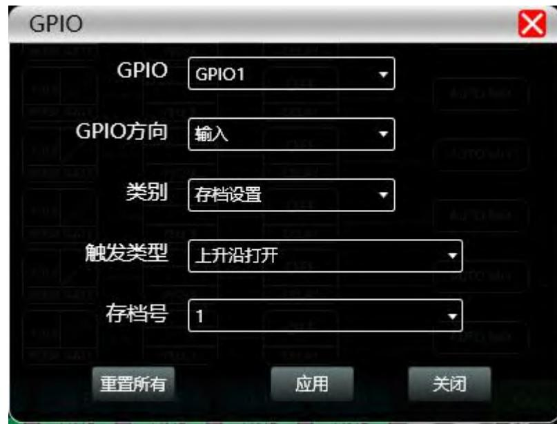
6、选择GPIO方向为**输入**时，如下图设置，点击下方“应用”使之生效。当GPIO 1 口触发上升沿打开时，输入通道3的信号路由到输出通道4，可通过更改输出触发类型，以获得同样效果。
