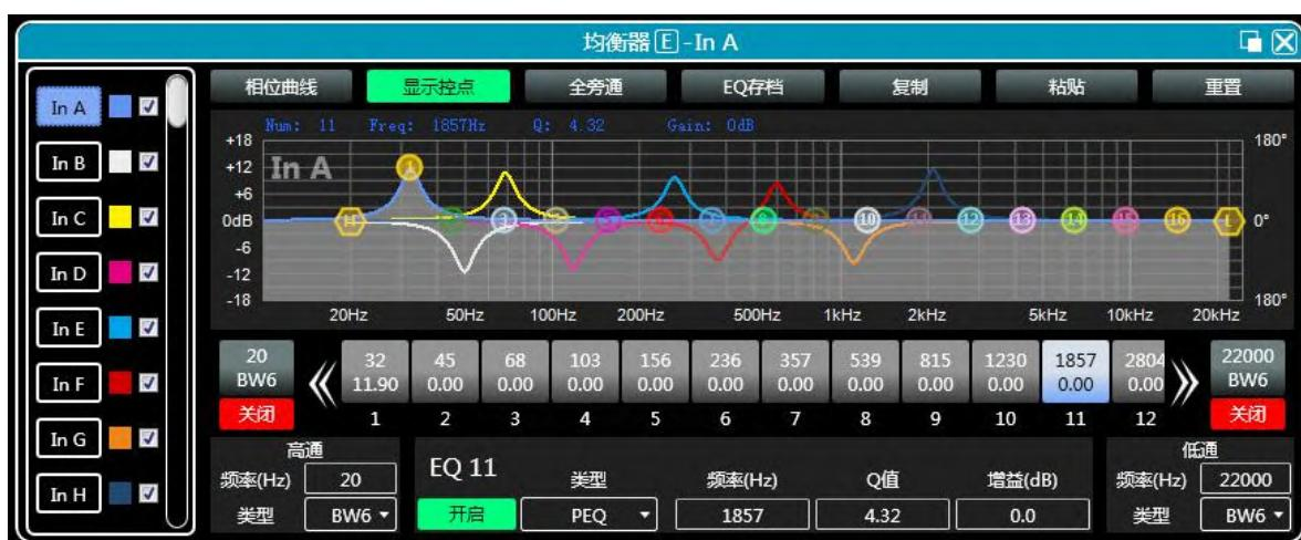
如上图6.1所示，左侧为每个通道的EQ曲线显示开关，打开后即会在EQ曲线图表中画出对应通道的曲线。
