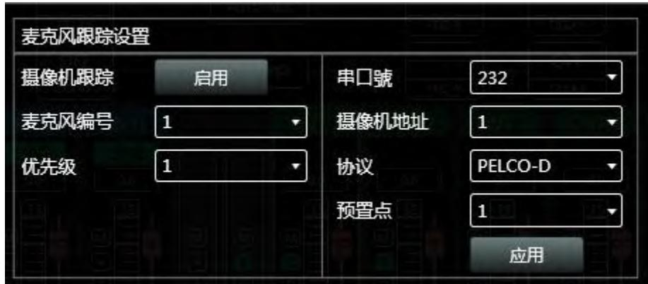
**麦克风的编号：**与设备的输入通道对应，即是该麦克所连接的通道号。 **(每个通道需要单独设置参数)**
