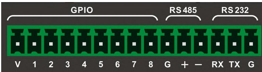
V：表示5V，是机器内部稳压输出DC 5V 600mA
