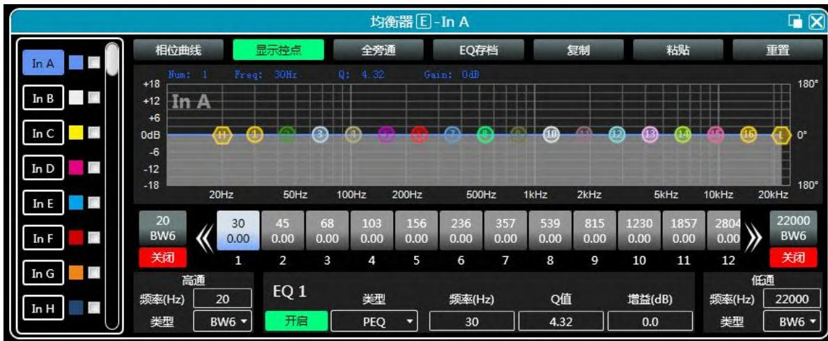
图6.1输入均衡器设置模块
