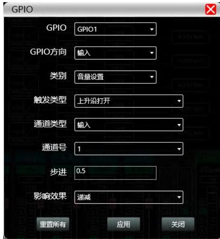
8、选择GPIO方向为**输入**时，如下图设置，点击下方“应用”使之生效。当GPIO 1 口触发上升沿打开时，输入通道 1 静音，可通过更改触发类型、通道类型、通道号，以获得同样效果。
