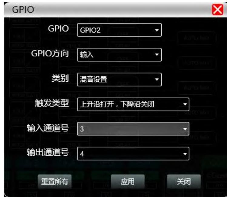
7、选择GPIO方向为**输入**时，如下图设置，点击下方“应用”使之生效。当GPIO 1 口触发上升沿打开时，输入通道 1 递减0.5dB，可通过更改通道类型、步进数值、影响效果，以获得同样效果。
