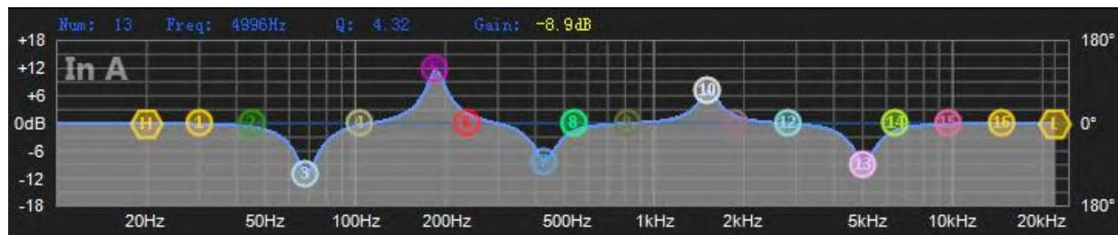
如上图6.1所示，用于控制及显示当前通道EQ曲线，图表中的对应多段控点可用鼠标点击上下左右拖动来调整EQ曲线。
