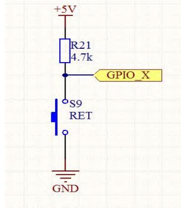
上升沿产生的方法，电路原理图如下图所示，+5V就用GPIO的V口输出的5V就可以。GPIO X代表想要操作的GPIO口，中间接了一个轻触开关，当按一下开关就产生一个上升沿。
